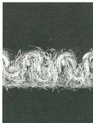
Querschnitt durch eine Carpetta Com-Back-Qualität: Obergewebe und Rücken sind fest miteinander vernadelt
